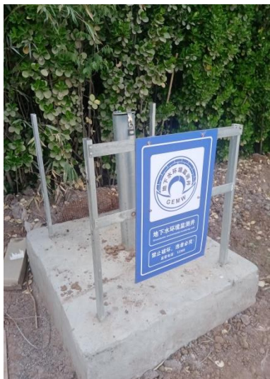
1#地下水监测井
